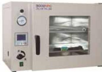
真空干燥箱采用模拟工程学的数字技术控制真空度，通过电磁阀全自动数显控制仪控制真空度，为您提供更加精确有效的真空度控制。通过面板设置，真空度从0pa至105pa可调，可调精度为1pa。传感器采用电阻硅管压力传感器，从而保证了稳定的压力值，不受气流的影响，把稳定的压力值传给真空控制仪LED显示屏上。配合相应大功率的真空泵，真空箱内最低真空度可以达到10pa以下军工级别。
