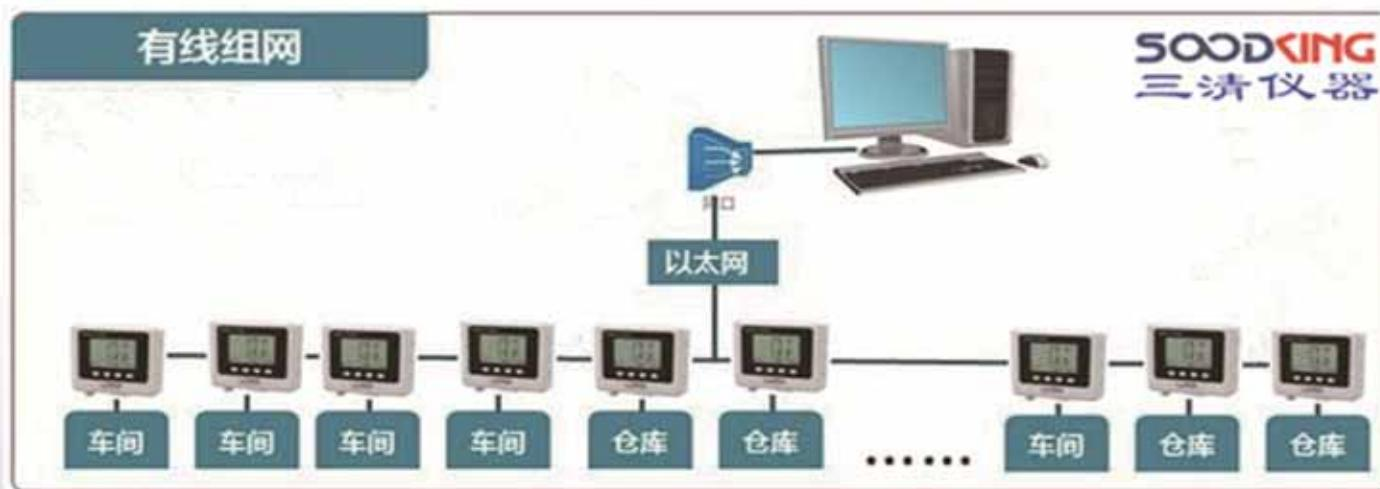
温湿度设备包括防潮箱，氮气柜，温湿度记录显示器通过TCP/IP协议组成局域网，搭配专业温湿度记录软件，实现工厂车间温湿度智能管理，可在电脑终端设置，管理，输出温湿度曲线图，查验存放物料环境的异常情况，报警提示等功能。
